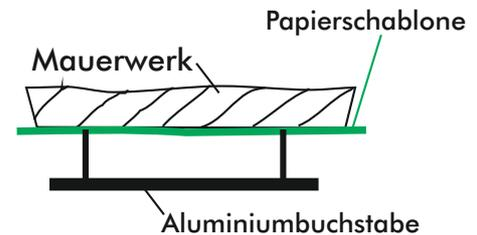
2. An den Montagepunkten, genau im Winkel von 90°, die Bohrungen von mindestens  $\varnothing$  6 mm in das Mauerwerk vornehmen.
