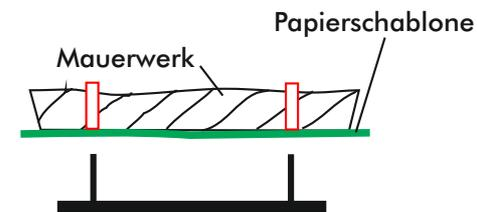
3. Bohrungen mit Montagekleber ausfüllen und die Gewindebolzen in die Bohrungen drücken. Beim Einlassen der Bolzen keine Gewalt anwenden!
